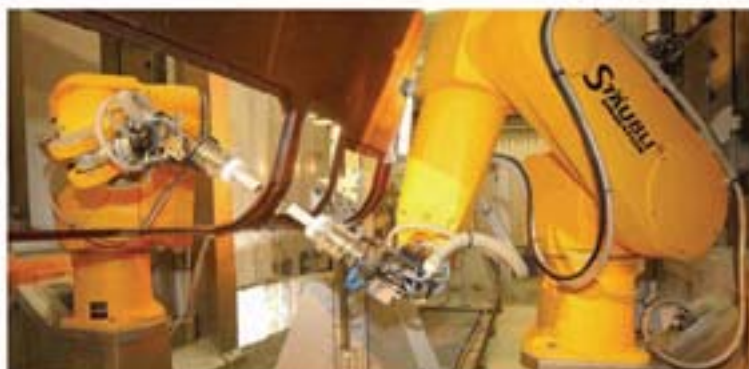
Twin Robotic ultrasonic squirter inspection system 雙機械臂超聲波噴水檢測系統
