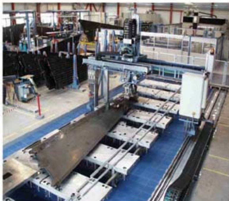
Twin Robotic ultrasonic squirter inspection system 雙機械臂超聲波噴水檢測系統
